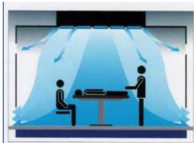
Fig. 4 Lay-Out di distribuzione dell'aria all'interno della Sala
