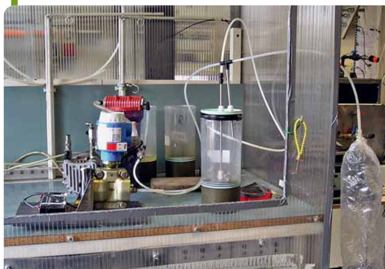
Foto 3 - Apparato per il prelievo del campione di odore
