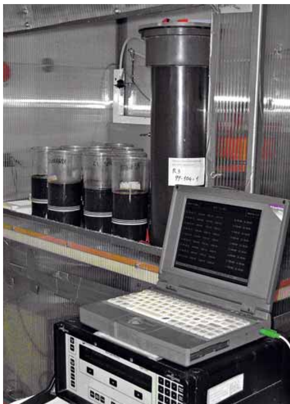
Foto 1 - Dispositivo utilizzato per la misura del potenziale emissivo dei liquami
